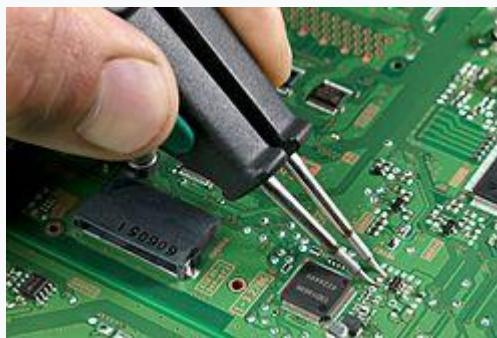
Postupak mekog lemljenja na tiskanoj pločici.
